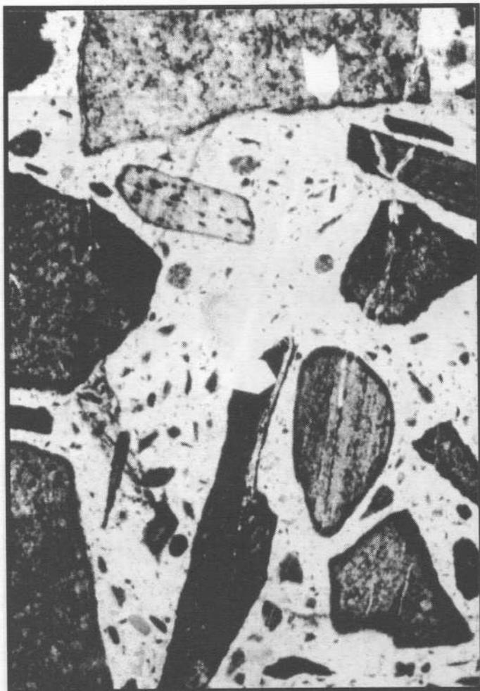
**FOTO 12.8 .- FLECHAS INDICANDO UBICACION DEL GEL DE LA REACCION ALCALINA EN LA INTERFASE AGREGADO-PASTA (Ref. 5.14)**
