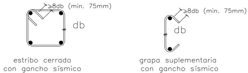
Fig. 21.1d Ganchos sísmicos en estribos y grapas suplementarias
